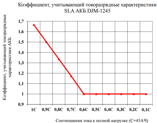
Рисунок 3. Коэффициент, учитывающий токоразрядные характеристики АКБ LEOCH DJM 1245.
