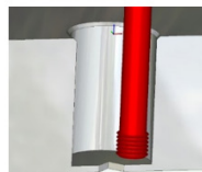
Рисунок 7. Действие 1. Фреза устанавливается так, чтобы первый зуб от её торца располагался на глубине большей, чем длина резьбы на 0,25 шага, то есть 181,5мм и подводится к заходной точке на диаметр 90% от внутреннего диаметра резьбы.
