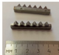
Рисунок 6. Режущие элементы в виде гребёнок из твёрдого сплава.
