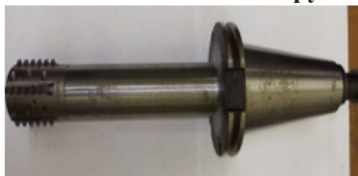
Рисунок 4. Оправка для патрона в сборе с насадной фрезой и твердосплавными пластинами в виде гребёнок.
