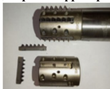
Рисунок 5. Насадная фреза и твердосплавные режущие элементы.
