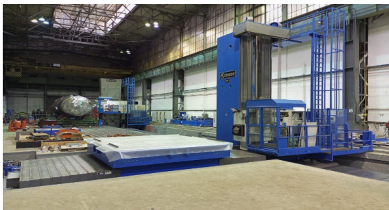
Рисунок 3. Обрабатывающий центр тяжёлой серии с двумя стойками «Skoda».
