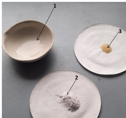
Рисунок 5 – Заготовки перед приготовлением суспензии: 1 – дистиллированная вода, 2 – ГАП, 3 – желатин
