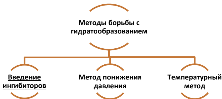
Рис. 2. Основные методы предотвращения гидратообразования
