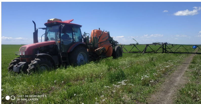
Рисунок 2 – Агрегат (Беларусь 1523 + AMAZONE UX) обрабатывает посевы пшеницы.
