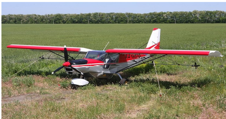
Рисунок 1 - Самолет СП-30 для обработки посевов пшеницы гербицидами.
