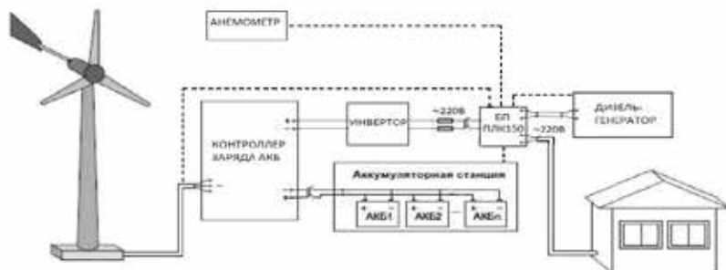
Рис. 1. Структура системы управления бесперебойного питания объекта
