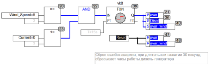
Рис. 5. Программа сигнализации аварийного режима работы ветрогенератора и переход в аварийный режим сети
