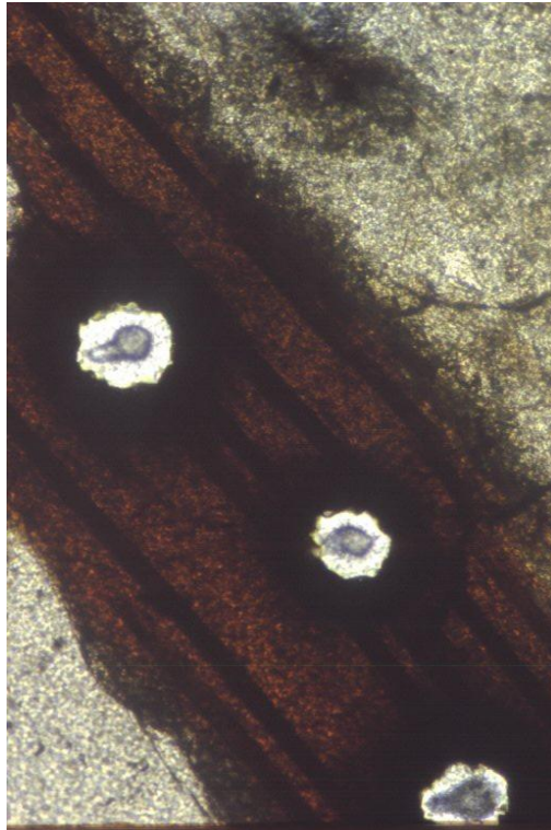
Рис. 2. Зерно биотита в прозрачном сэндвич-шлифе после облучения и лазерного зондирования, размер кратеров около 100 мкм.
