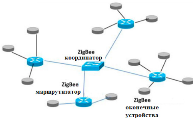
Рис. 1. Структура Mesh-сети. Устройства, оснащенные модулями ZigBee, совмещены со средствами, которые используются для хранения информации, устанавливаются на беспроводные модули и программируются на снятие и передачу данных, после чего полученные данные оперативно передаются в центр контроля и управления, из которого специальное программное обеспечение осуществляет мониторинг сети.
