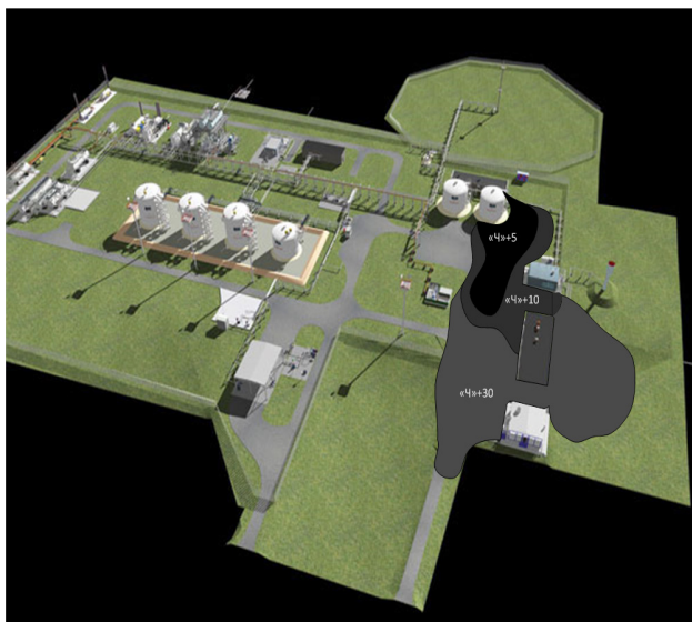
Рис. 1. Разлив нефтепродукта при разрушении РВС-10000 при разрушенном каре
