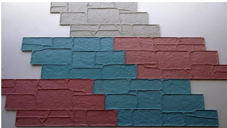
Рис. 3. Штампы для создания фактурной поверхности бетона
