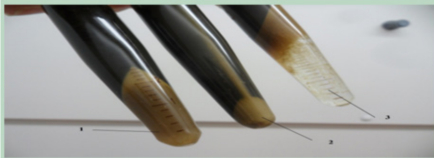
Рисунок 1-Результаты центрифугирования нефти: 1-проба нефти Б; 2-проба нефти А, 3-проба нефти В.
