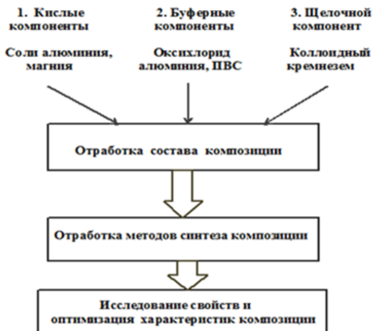
Рисунок 1 – Схема приготовления бурового раствора с управляемым гелеобразованием (БРУГ) по временным параметрам
