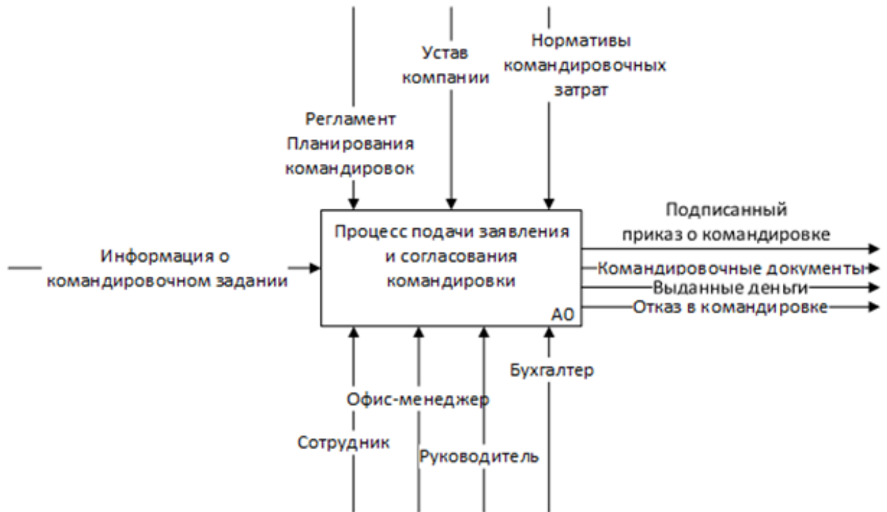
Рисунок 1 - Модель в нотации IDEF0 процесса подачи заявки на командировку и ее утверждение «как есть»
