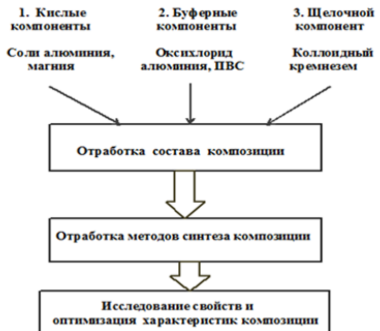
Рисунок 1 – Схема приготовления бурового раствора с управляемым гелеобразованием (БРКУГ) по временным параметрам
