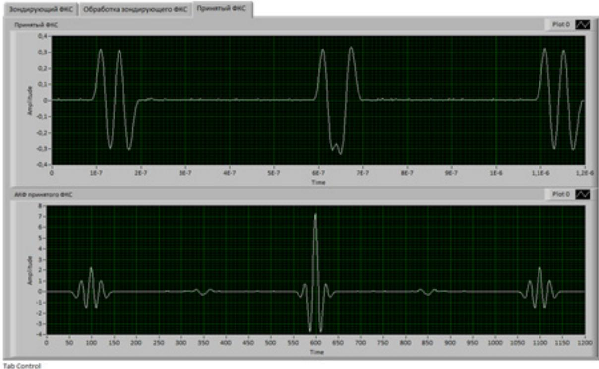
Рисунок 4 – Принятый сигнал и его АКФ
