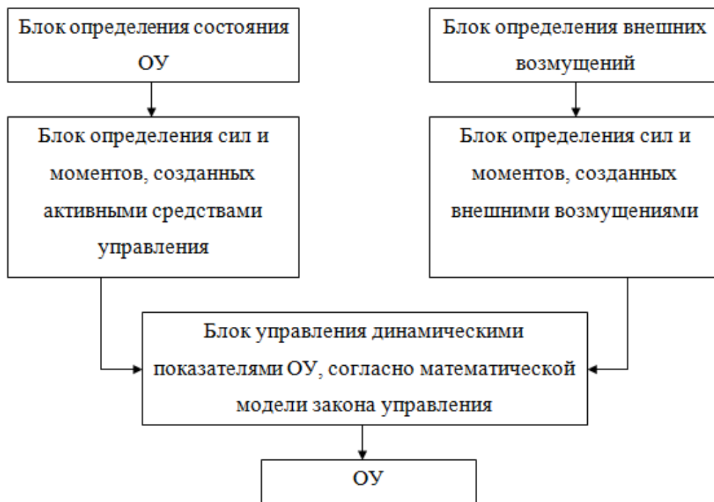
Рисунок 1 - Общая структурная схема алгоритма управления
