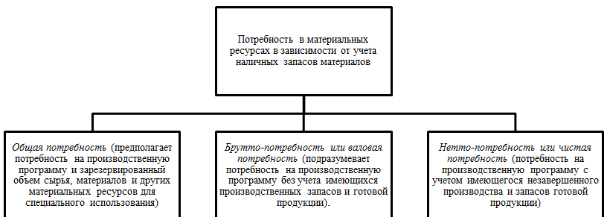
Рисунок 2 - Классификация потребностей в материальных ресурсах в зависимости от учета наличных запасов материалов
