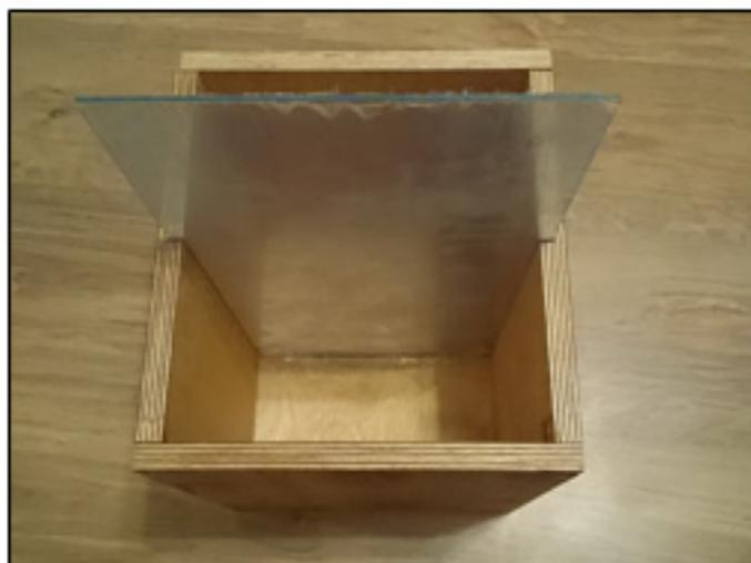
**Рисунок 1 - Модель для проведения лабораторных испытаний грунтового массива**
