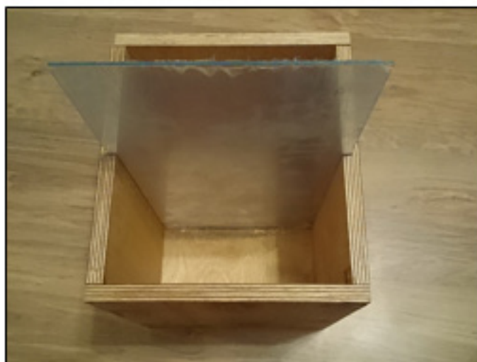
Рисунок 1 - Модель для проведения лабораторных испытаний грунтового массива
