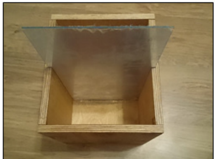
Рисунок 1 - Модель для проведения лабораторных испытаний грунтового массива
