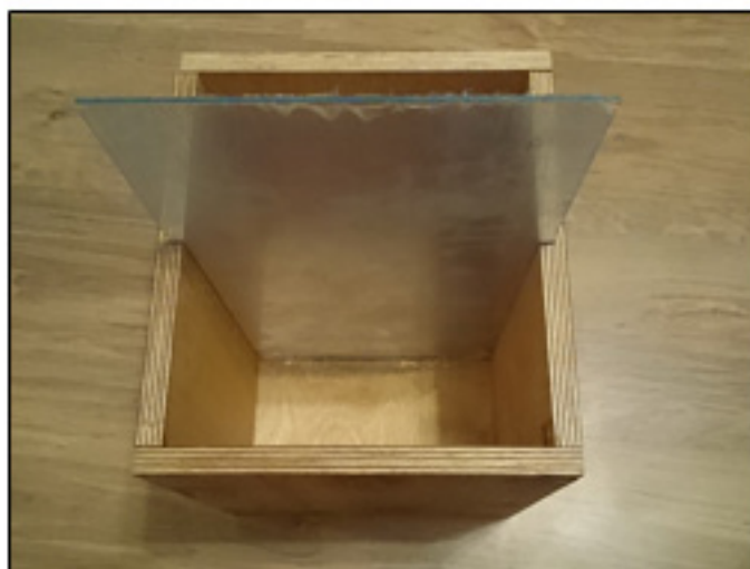
Рисунок 1 - Модель для проведения лабораторных испытаний грунтового массива
