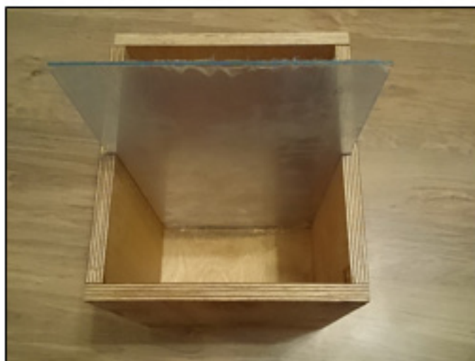
Рисунок 1 - Модель для проведения лабораторных испытаний грунтового массива
