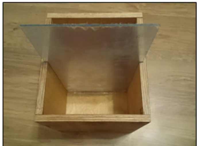
Рисунок 1 - Модель для проведения лабораторных испытаний грунтового массива
