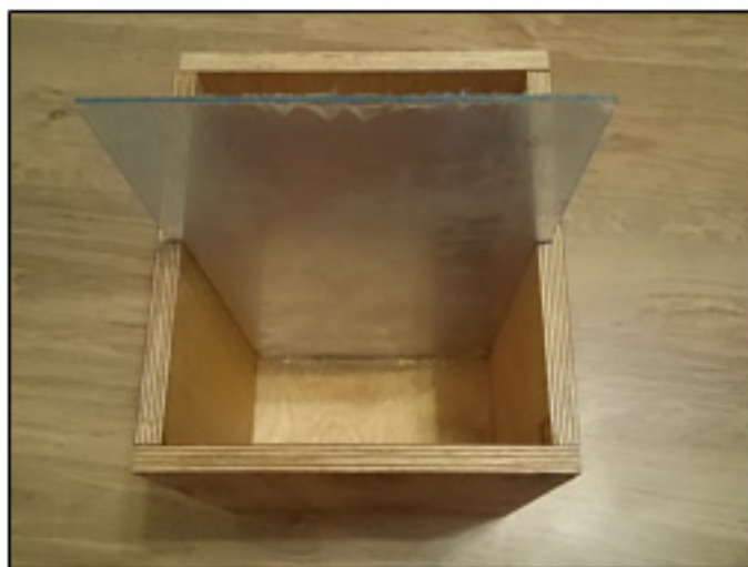
Рисунок 1 - Модель для проведения лабораторных испытаний грунтового массива
