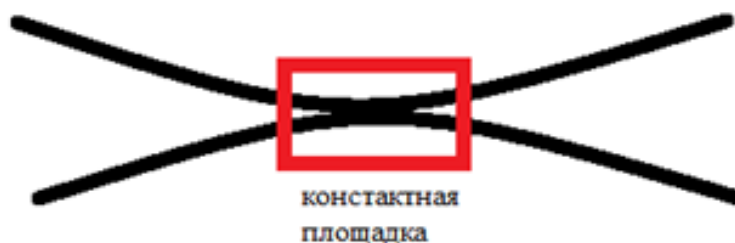
Рисунок 1 - Схематический рисунок биконического (сплавного) разветвителя х-типа
