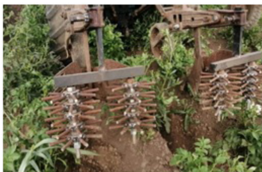
Рисунок 3. Общий вид окучника с устройством для мульчирования
