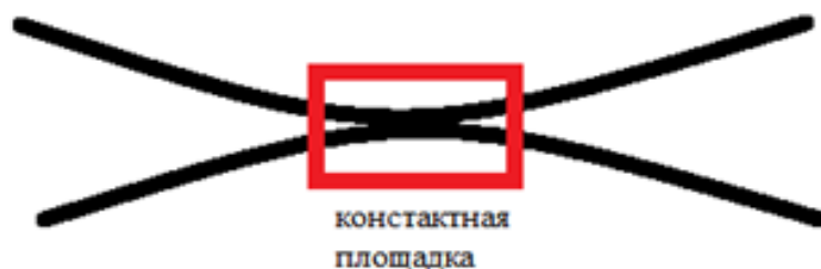
Рисунок 1 - Схематический рисунок биконического (сплавного) разветвителя X-типа
