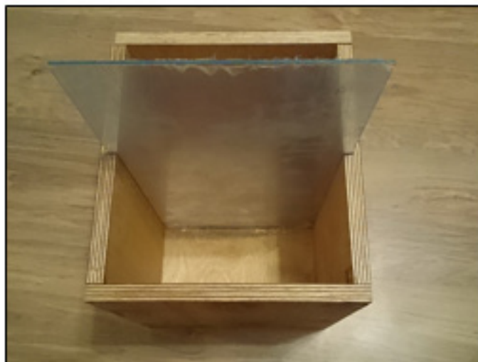
Рисунок 1 - Модель для проведения лабораторных испытаний грунтового массива
