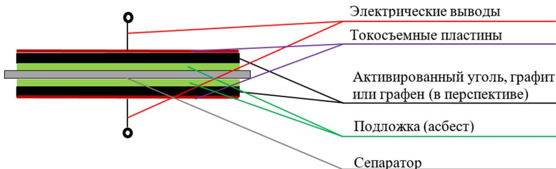
Рисунок 2 – Конструкция ионистора
