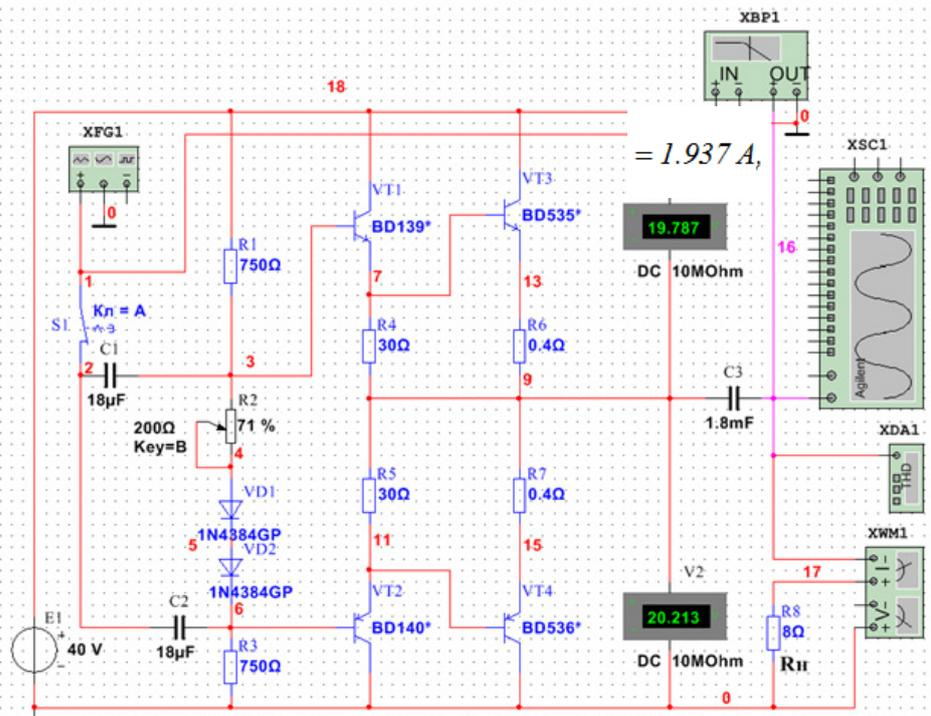
Рисунок 1 - Выходной каскад усилителя НЧ
