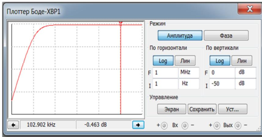
Рисунок 4 - АЧХ на верхней рабочей частоте
