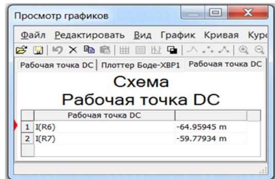
Рисунок 2 - Ток покоя выходных транзисторов
