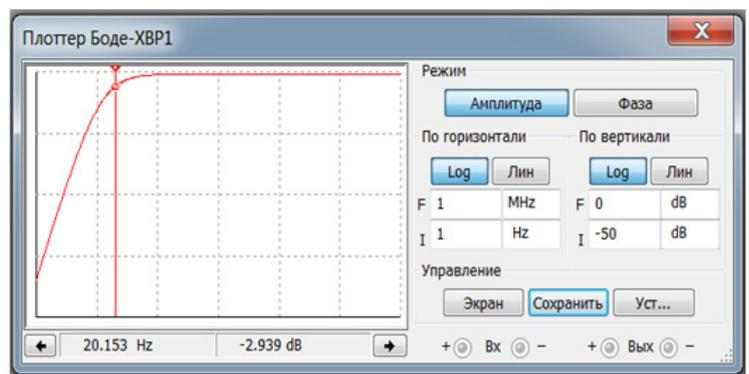
Рисунок 3 - АЧХ на нижней рабочей частоте
