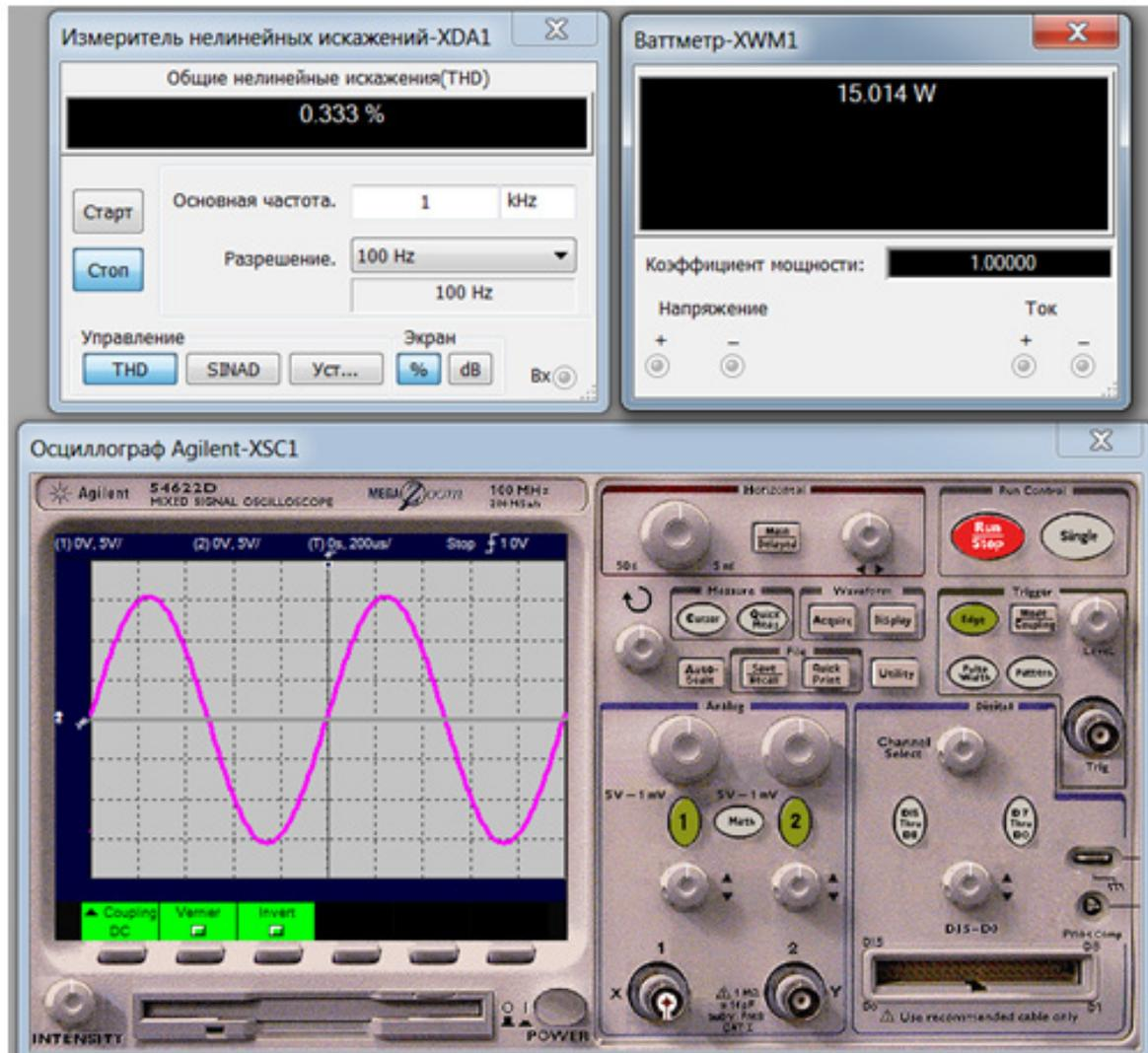
Рисунок 5 - Коэффициент нелинейных искажений при максимальной мощности
