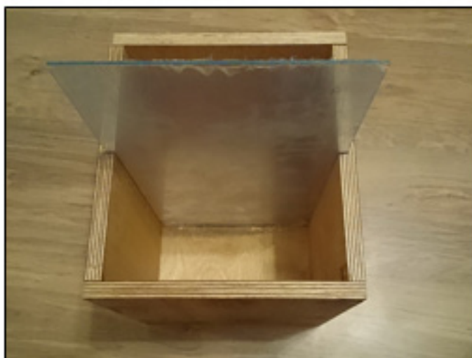
Рисунок 1 - Модель для проведения лабораторных испытаний грунтового массива
