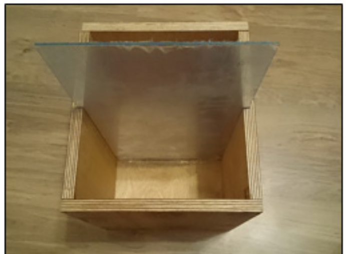
Рисунок 1 - Модель для проведения лабораторных испытаний грунтового массива
