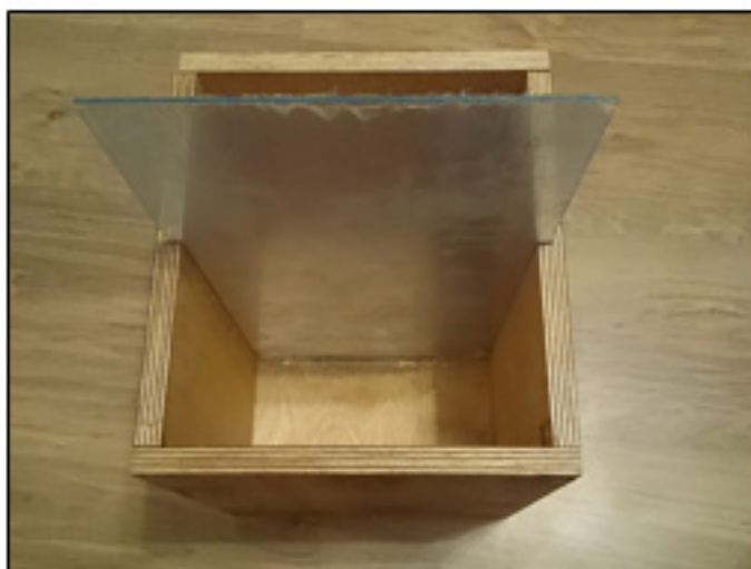
Рисунок 1 - Модель для проведения лабораторных испытаний грунтового массива
